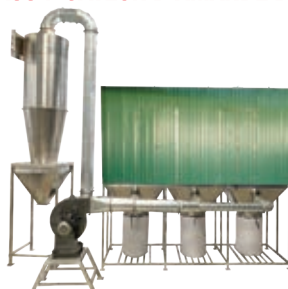
DUST COLLECTOR SYSTEM FOR PEELING MACHINE ASPIRATEUR DE POUSSIÈRES
